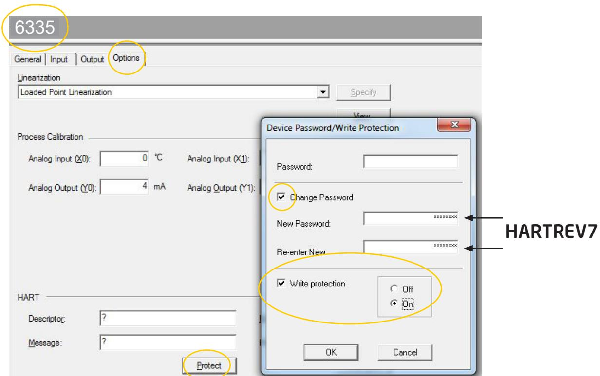
Отключите Write protection (Зашита записи), нажав OFF (ОТКЛ) и разрешите запись на устройстве вводом Password "-**CHANGE-**" (Пароль -ИЗМЕНИТЬ-) в верхнем меню - подтвердите нажатием OK.
